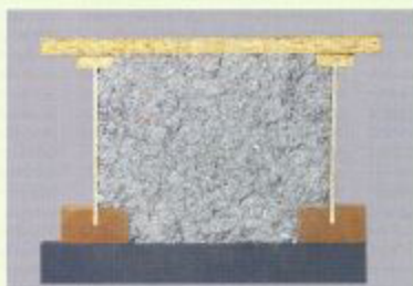
Zur Dämmung der oberen Geschosdecken wird der „Expander“ in einen gesetzten Dämmstreifen gesteckt.
