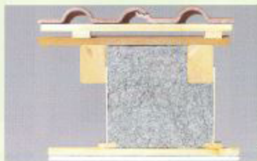
An den oft sehr schlanken Dachaufbau im Altbau wird der „Sparrenexpander“ seitlich befestigt und schafft Raum für eine 220 mm starke Wärmedämmung.
